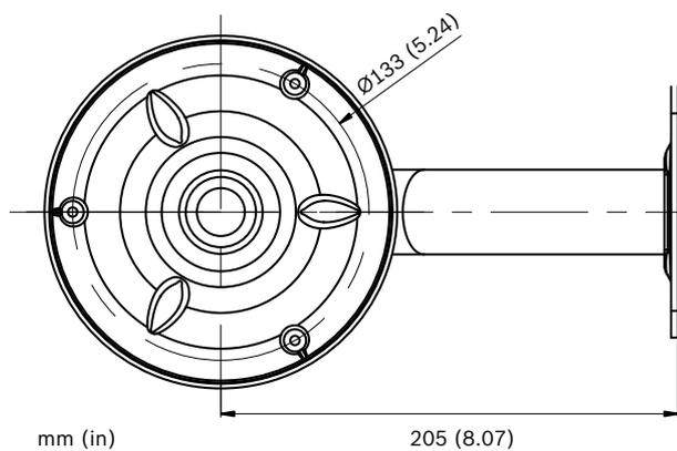
**VDA-PMT-DOME – подвесная установка на трубу**
