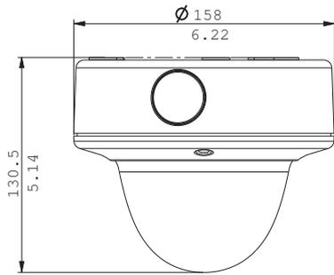
Размеры в мм (дюймах) для установки на поверхность
